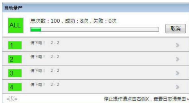
图 5.3 多机自动量产烧写界面
