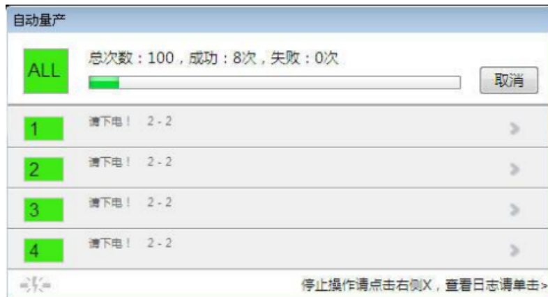
图 5.3 多机自动量产烧写界面
