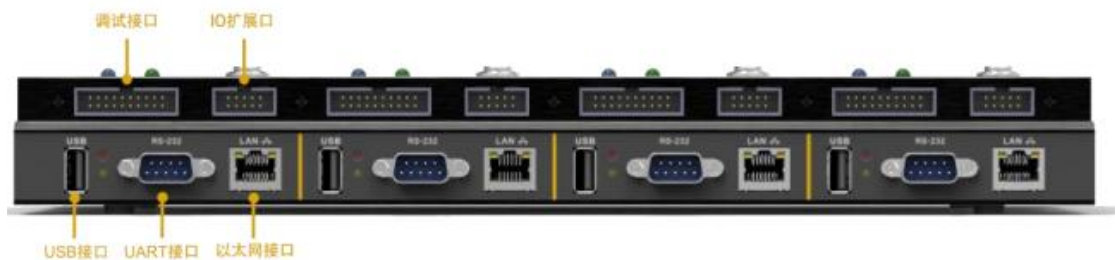
图 2.2 AK100Pro-4P 正面图（4 路编程接口）
