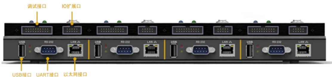
图 2.2 AK100Pro-4P 正面图（4 路编程接口）
