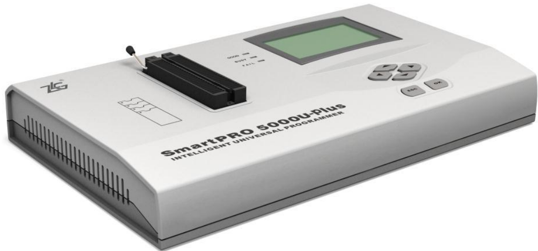
图 1.1 SmartPRO 5000U-Plus 通用编程器图片
