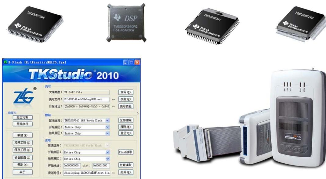
图 1 DK10 仿真器与 K-Flash 在线编程软件
